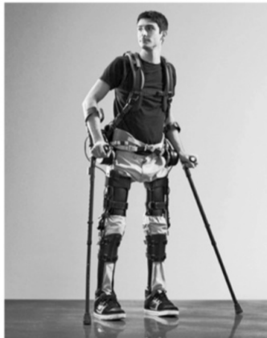
Рис. 8. Экзоскелет восполняет утраченные функции нижних конечностей
